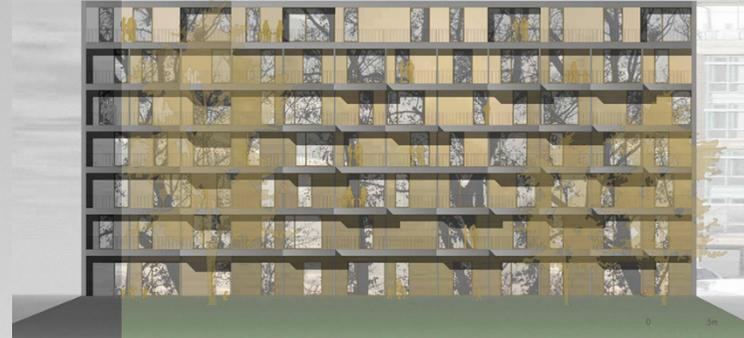
Die beiden Mehrfamilienhäuser einer Baugruppe in der Lück- und Leopoldstr. in Berlin Lichtenberg wurden als 6/7-geschossige Massivbauten in Stahlbeton und Mauerwerk errichtet.
